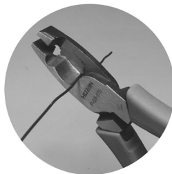
鉄バインド線の切断
