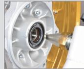
重量のあるホイールも先端のボス部分がハブベアリングに引っかかり安定した載せ降ろしが可能
