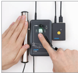
電極棒に触れるだけでも簡易的に測定可能
