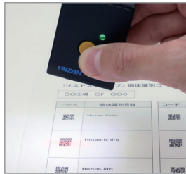
測定後、個体識別QRコードを読み取ると結果が記録され、データはmicroSDカードにCSVファイルとして保存されます。
