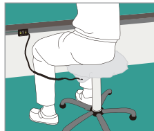
アース線を介してグラウンド 可能接続点と直接接続する 方式で、床が未対策でも 使用可能
