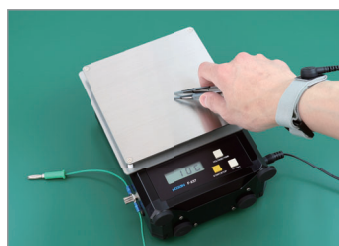
静電気対策アイテムの測定
