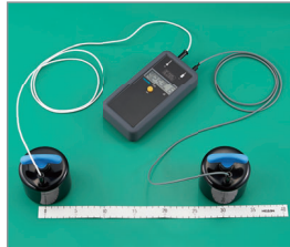
導電性カラーマット (点間抵抗/表面抵抗測定)
