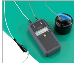
導電性カラーマット (グラウンド可能接続点への抵抗)
