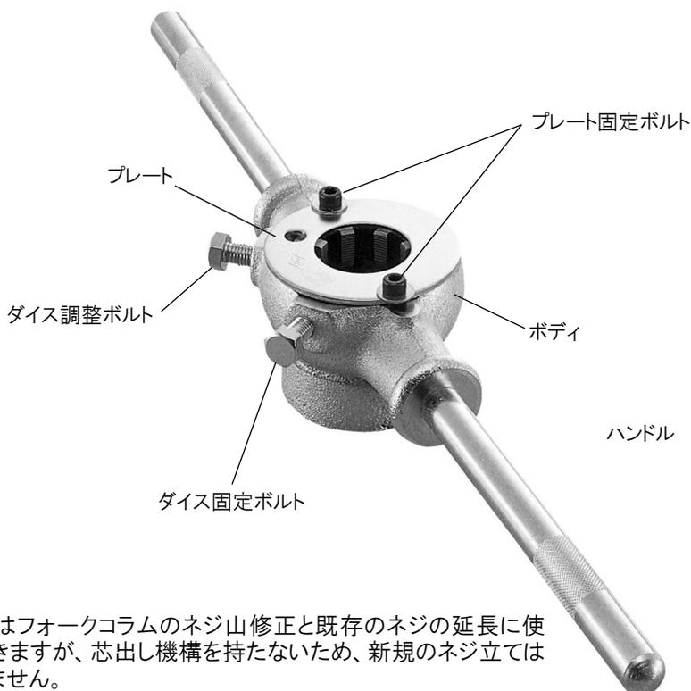
本器はフォーコラムのネジ山修正と既存のネジの延長に使用できますが、芯出し機構を持たないため、新規のネジ立てはできません。
