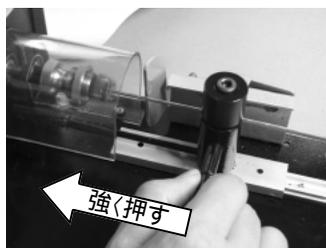
8 spokeがダイスに掛かり、spokeホルダーが自動的にスライドし始めたらレバーから手を離してください。
