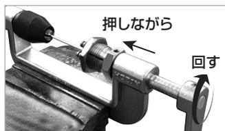
ダイスヘッド取付軸に刻まれた溝は3mm間隔となっておりますので、加工するネジの長さの目安にご利用ください。
