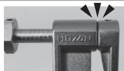
6. 必要な長さまでネジが形成されたら、ハンドルを反時計方向に回転させ、スポークからダイスヘッドが外れるまで後退させる
