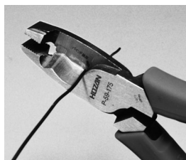
鉄バインド線の切断
