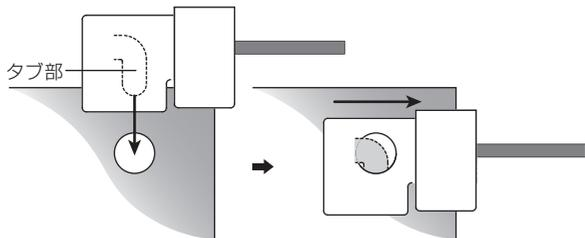
11 端子の上からEBPシールを貼り付け、固定したら取り付け完了です。
