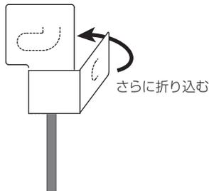
8 裏返して、芯線がはみ出ていないことを確認し、切り込みに爪を引っかけて固定します。
