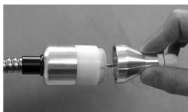
電極はそのまま手前に引き抜きます。挿入するときは電極の平らな面を受け側と合わせてください。フードを元通り取り付けます。
