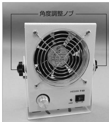
角度を固定する場合は、付属の角度固定ネジ(スプリングワッシャー・ワッシャー付)をご使用ください。角度調整ノブの下にあるネジ穴に差し込み、プラスドライバー⊕No.2で締め付けます。
