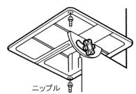
**8** 付属のニップルをK-100のテーブル下面2 カ所のネジ穴に取り付けます。
