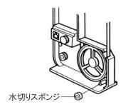
4 刃に接するように水切りスポンジを取り付けます。刃とともに流入した水が飛び散るのを防ぎます。
