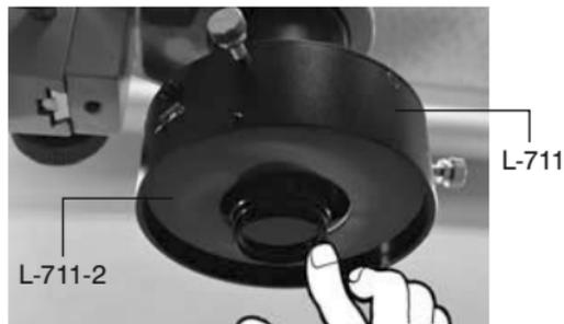
照明側の偏光方向と、本製品の偏光方向が90°のとき、効果が最大になります。
