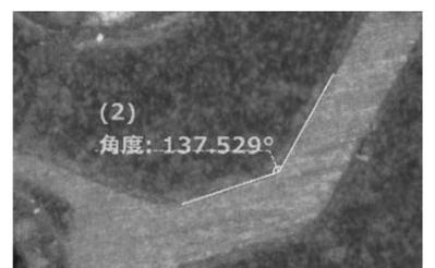
計測機能を用いることで、2点間距離や円の半径、面積、角度など、多彩な計測が可能です。
