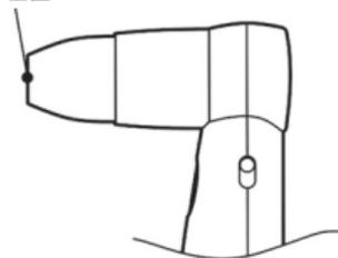
フォーカシングガイドを時計方向に回転させながら押し込むとノンコンタクトポジションになります。ノンコンタクトポジションでは、ピント位置から引いたところにフォーカシングガイドの先端がきますので、凹凸の激しい、あるいは接触を避けたい対象物の検視に適します。
