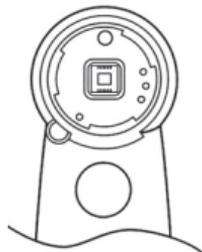
ハンドセットからレンズユニットを取り外したときにCMOS部が露出しますが、CMOS部には触れないでください。CMOS部が破損する恐れがあります。
