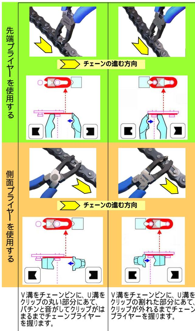
V溝をチェーンピンに、U溝をクリップの丸い部分にあて、パチンと音がしてクリップがはまるまでチェーンプライヤーを握ります。
