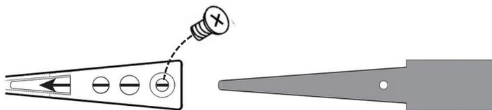
新しいチップに差し替え、先端同士（前後・左右）をよく合わせて、取付ネジを締めつけてください。
