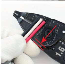
工具の端とスケールの “0”の距離
