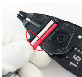
人差し指をVVFストリッパー の側面に当てる
