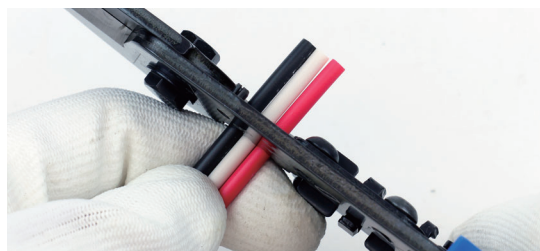
人差し指をVVFストリッパー の側面に当てる
